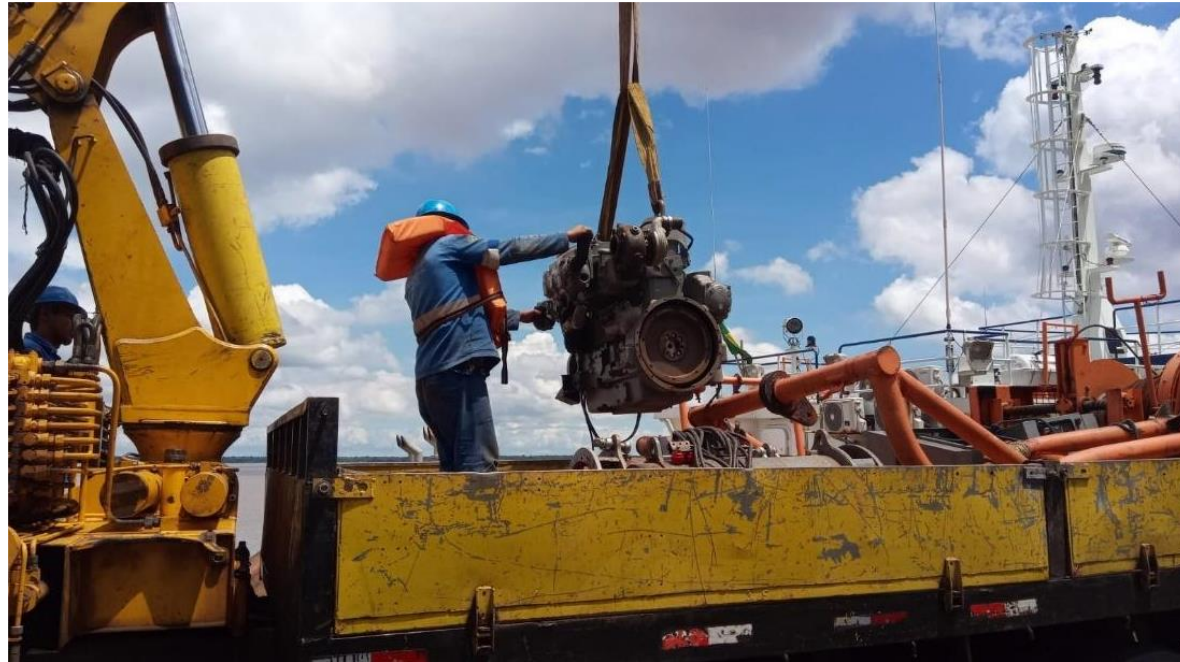
Figura 27: Retirada do motor do MCA que foi substituído. O mesmo foi levado para a garagem da UFMA.
