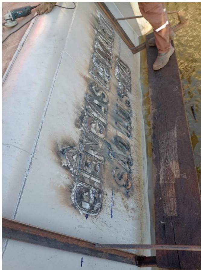
Figura 10b) Popa expandida e a fixação do letreiro na popa do NEP CM II.
