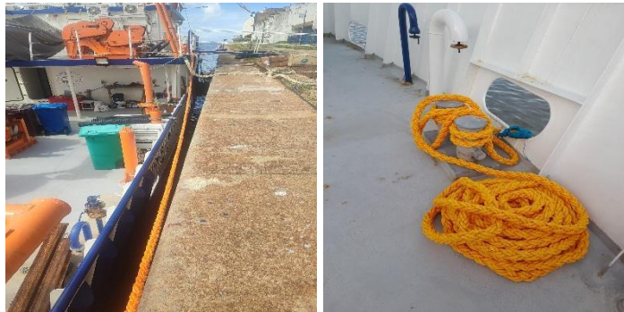
Figura 19. Espias de alta resistência utilizadas na atracação.
