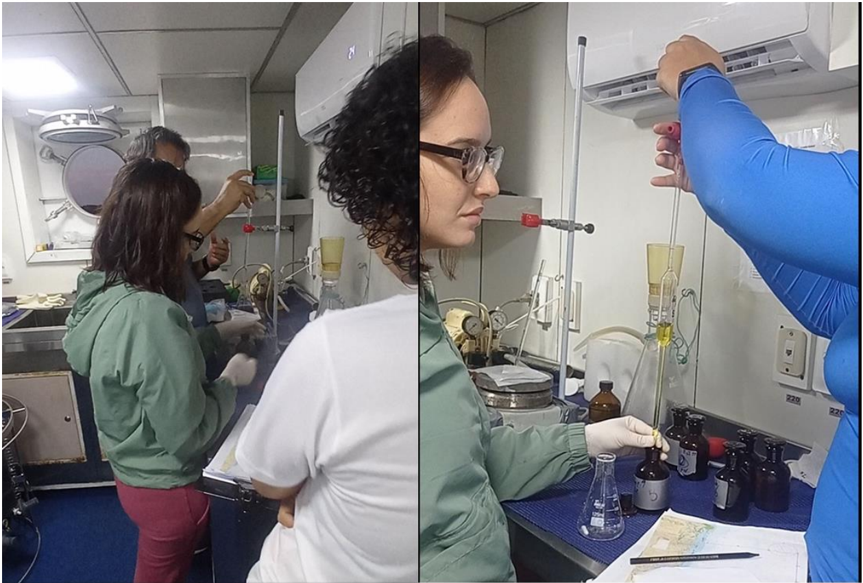
Figura 2 Laboratório Molhado: Preparação para fixação de oxigênio dissolvido. Professor e alunas na foto.
