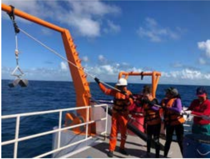
Figura 13 Lançamento da draga
