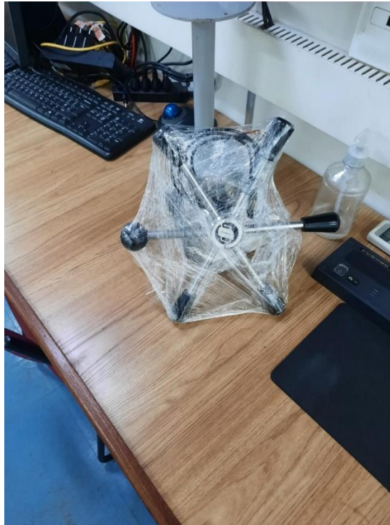
Figura 3a) Timão do comando de ré. Esta foi a última peça que faltava para a restauração do comando e ré da embarcação.
