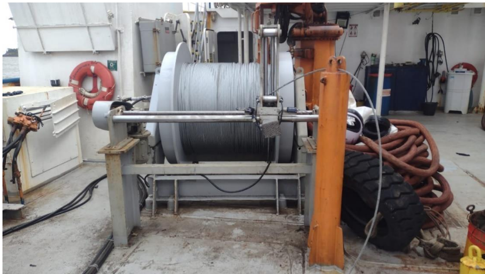
Figura 2-a) Guincho hidráulico instalado no navio.
