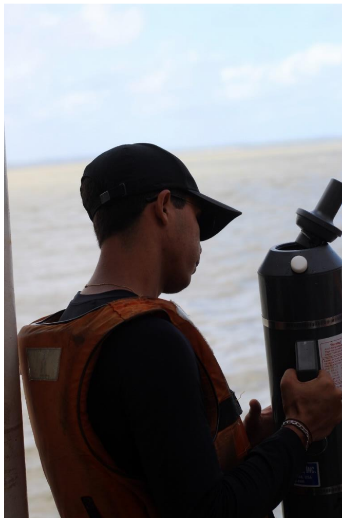
Figura 12: Garrafas de Niskin com mensageiros para coleta de água.
