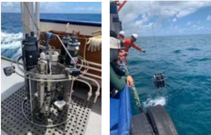
Figura 07: Lançamentos de equipamentos oceanográficos (CTD-Rosette) a bordo do Navio Ciências do Mar IV no dia 23/11/2013.
