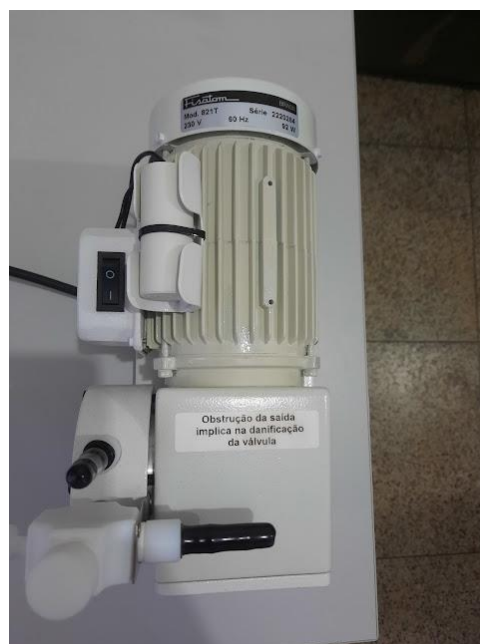
Figura 14 : Bomba de vácuo do sistema de filtração.
