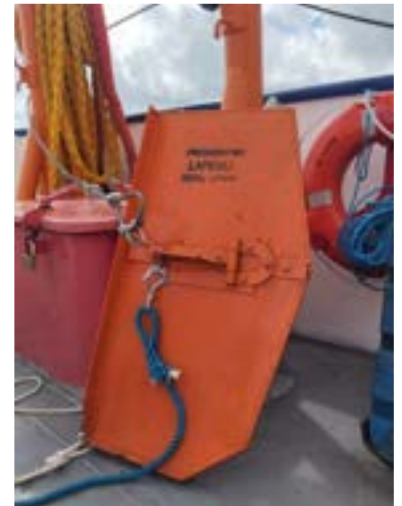
Figura 9 Porta no formato vertical em V (desenvolvida pelo professor Vanildo).
