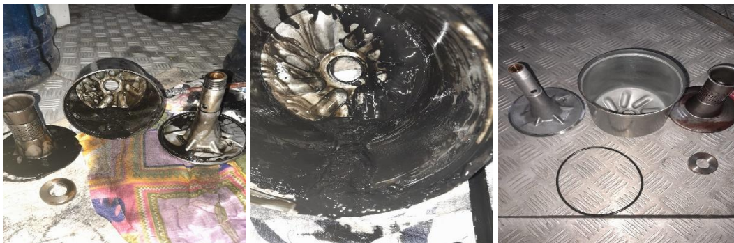
Figura 3. Limpeza dos filtros dos MCPs.
