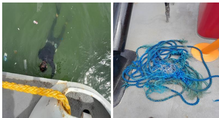
Figura 16. Material removido do eixo do hélice.
